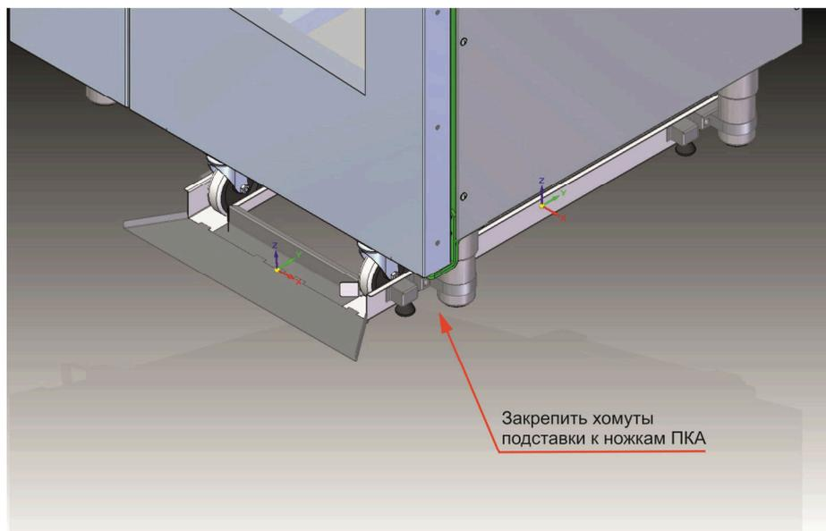
2. Выставить подставку и ПКА по высоте (при этом обеспечить горизонтальность установки подставки, одинаковое расстояние при выкручивании ножек ПКА и подставки). Начальная высота от пола до каркаса ПКА составляет 175 мм. В конечном положении ножку подставки зафиксировать контргайкой М8.
